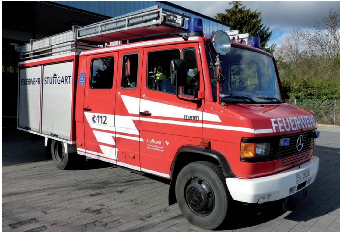
Das LF8/6 wird bei jedem Alarm als erstes Fahrzeug eingesetzt, sei es ein Mülleimerbrand oder ein Großalarm am Flughafen. In dem Löschgruppenfahrzeug hat (wie der Name schon sagt) eine Gruppe Platz, das entspricht 9 Feuerwehrleuten.
